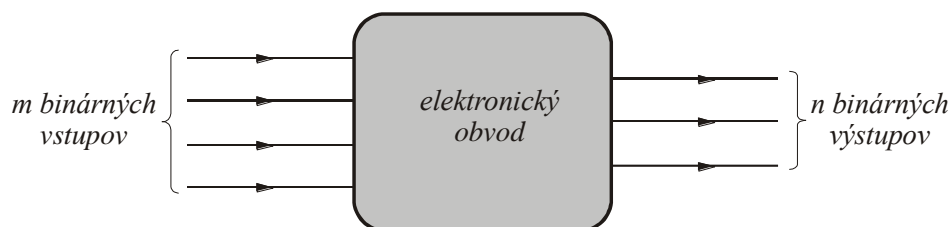
Obrázok 10.1. Známenie elektronického obvodu, ktorý má m binárnych vstupov a n binárnych výstupov. Činnosť elektronického obvodu spočíva v transformácii binárnych vstupných hodnôt na binárne výstupné hodnoty.
