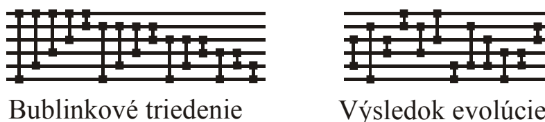
Obrázok 10.7. Korektné siete na triedenie sady čísel podľa veľkosti. Jeden z často používaných algoritmov na triedenie, tzv. bublinkové triedenie (bubble sort), dokáže zoradiť 6 čísel s použitím 15 porovnaní, zatiaľ čo jednej z minimálnych korektných sietí napravo stačí iba 12 porovnaní. Takýchto minimálnych korektných sietí existuje viac (môžeme napríklad prehodiť prvé dve porovnania).
